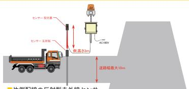
■片側配線の反射型赤外線センサー
