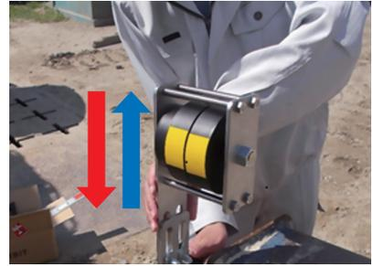
0セット(設定した法面勾配)状態からバケットを開けば赤矢印の方向へ、巻けば青矢印の方向へ動環が動きます
