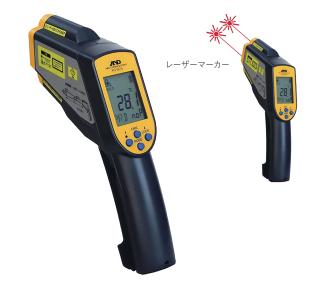
±2%または±2°Cのいずれか大きい値(-33°C~1500°C) 精 度  $0.1^{\circ}$ C(-60°C~+999.9°C)、その他は $1^{\circ}$ C 0.10~1.00まで0,01きざみ設定(変更)可能 約1秒(90%) :測定範囲 50:1 クラス2(JIS C 6802) レーザー波長635~660nm 出力パワー1mW以下 単4乾電池×2本/約12時間 電源/電池寿命 (連続使用時、アルカリ電池使用) 47(W)×197(H)×203(D)mm/約385g(電池を含む) 単4乾電池×2本
