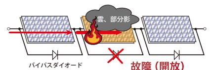
開放故障していると、影ができた時**強引に不具合セルに電流を流すため発熱し、火災を引き起こす危険性があります。**
