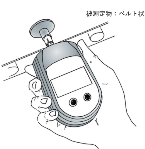
速度計測ホイルを取付けての速度計測
