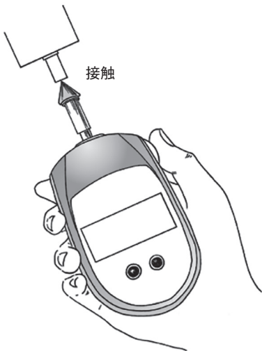
モーターの回転速度計測
