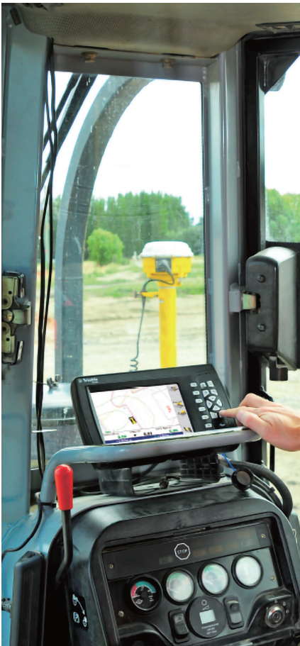
GCS900 3D for Dozers システム構成図
