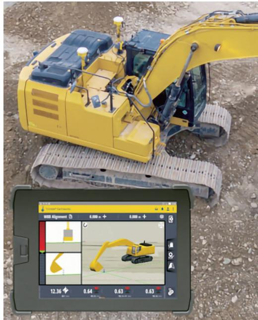
Trimble Earthworks MG（マシンガイダンス）は、トータルステーションやGNSS受信機等の高精度位置情報と油圧ショベルのバケットやアーム、ブームや機体に取り付けたIMUセンサー、コンピュータ、通信装置等により、3次元設計データと建機の刃先の位置関係をリアルタイムで算出比較します。
